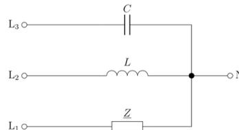
Wie groß müssen Sie den Verbraucher  $Z$  nach Betrag und Phasenwinkel wählen, damit der Strom im Mittelleiter zu Null wird?
