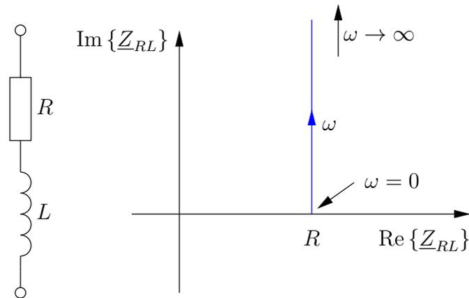
Der Realteil besitzt unabhängig von  $\omega$  den konstanten Wert  $R$ . Für  $\omega = 0$  ist der Imaginärteil Null und wird linear mit wachsendem  $\omega$  größer.
