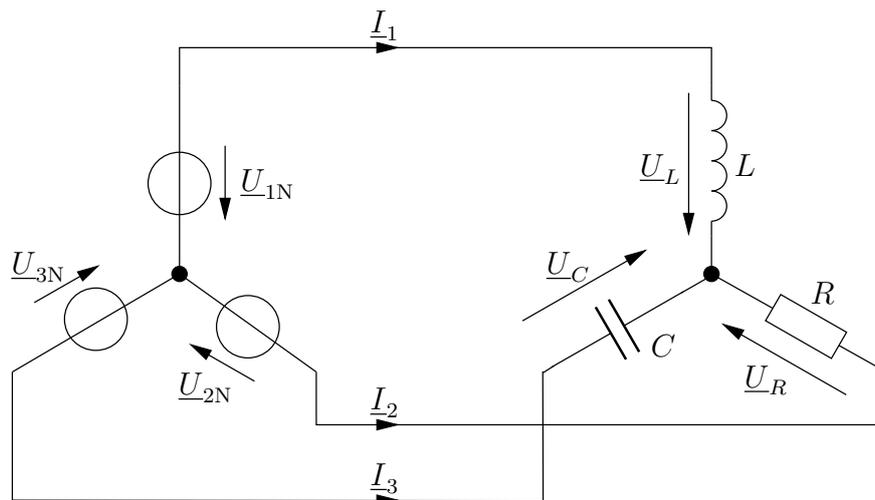
Die Wechselspannungsquellen bilden ein Drehstrom-Erzeugersystem:
