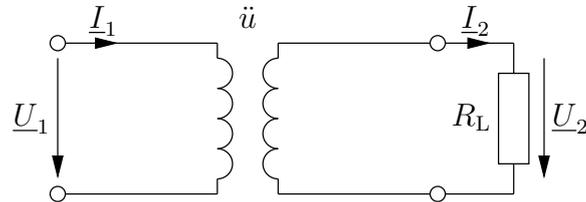
Auf der Primärseite liegt die Spannung  $U_1$  an, es fließt der Strom  $I_1$ . Der Trafo nimmt also die Leistung  $P = U_1 \cdot I_1$  auf. Da er verlustlos ist, muss diese Leistung im Lastwiderstand  $R_L$  umgesetzt werden. Damit lässt sich der sekundärseitige Strom berechnen:
