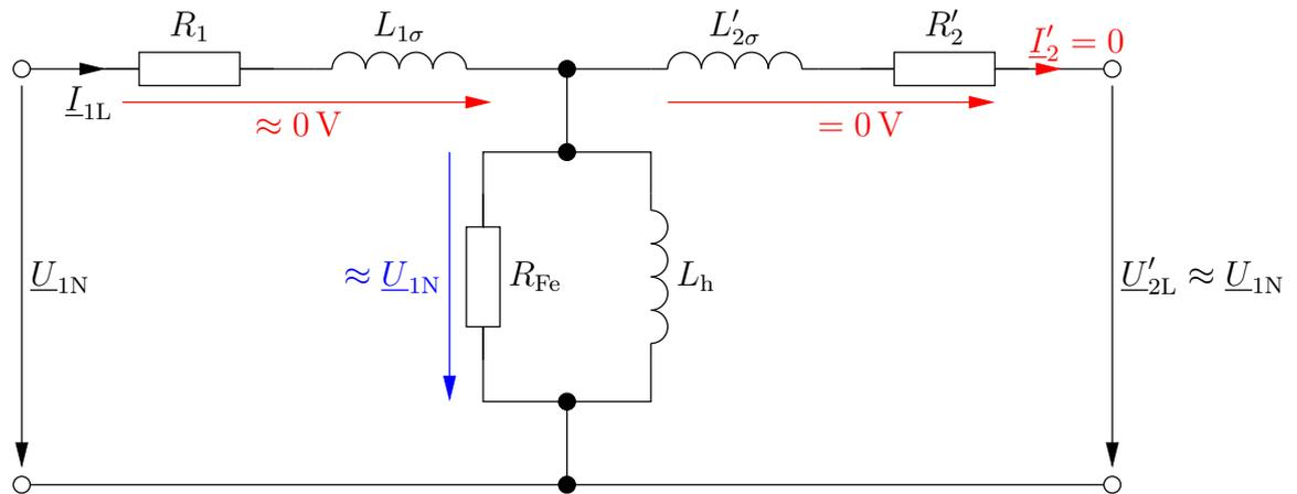
Für die weitere Betrachtung muss man sich darüber im klaren sein, dass  $R_1 \ll R_{\text{Fe}}$  (die Wicklungsverluste sind gegenüber der Eisenverluste vernachlässigbar) und  $L_{1\sigma} \ll L_h$  (die Streuinduktivität ist gegenüber der Hauptinduktivität vernachlässigbar). Dies bewirkt, dass im Ersatzschaltbild nahezu die gesamte Spannung  $\underline{U}_{1N}$  an  $R_{\text{Fe}}$  und  $L_h$  abfällt.
