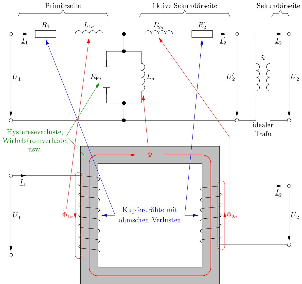
Die Ohmschen Widerstände  $R_1$  und  $R'_2$  repräsentieren die Verluste in den Drahtwicklungen (ohmsche Verluste, Stromverdrängung). Der von den Wicklungsströmen verursachte magnetische Fluss  $\Phi$  wird hauptsächlich im Eisenkern geführt (im Ersatzschaltbild repräsentiert durch  $L_h$ ) und verkoppelt die Stromkreise der Primär- und
