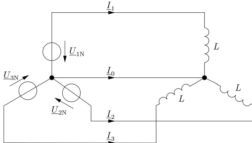
Die Wechselspannungsquellen sind im Stern verschaltet und bilden ein Drehstrom-Erzeugersystem:
