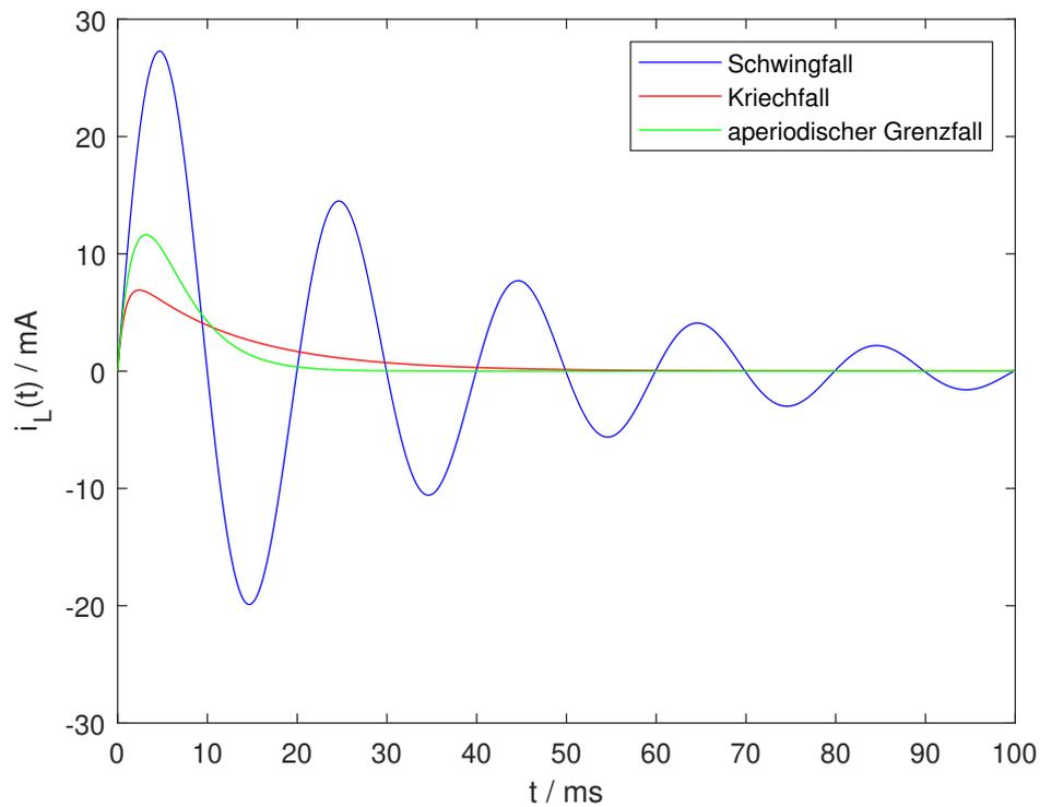
Abbildung 8.4.: Zeitverläufe des Stroms  $i_L(t)$  der Schaltung in Abb. 8.3 für  $U_0 = 10\text{ V}$ ,  $L = 1\text{ H}$ ,  $C = 10\text{ }\mu\text{F}$  und  $R = \frac{2}{10}\sqrt{\frac{L}{C}}$ ,  $R = 4\sqrt{\frac{L}{C}}$  bzw.  $R = 2\sqrt{\frac{L}{C}}$
