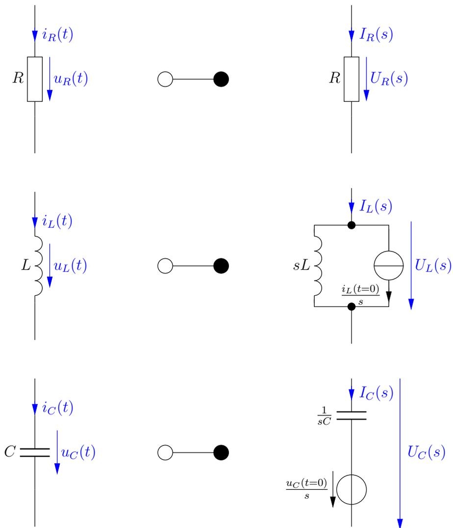
Abbildung 8.1.: Transformation der passiven Bauelemente in den Bildbereich
