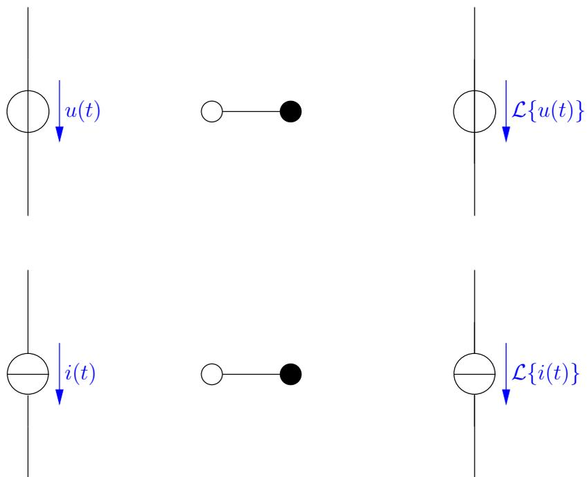
Abbildung 8.2.: Transformation der aktiven Bauelemente in den Bildbereich
