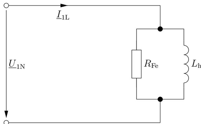
In der Praxis kann man nun  $U_{1N}$  und  $I_{1L}$  (also die Beträge) messen und benötigt eine weitere Größe. Entweder misst man die im Transformator umgesetzte Wirkleistung  $P_L$ , oder den Phasenverschiebungswinkel  $\varphi_L$  zwischen  $U_{1N}$  und  $I_{1L}$ .
