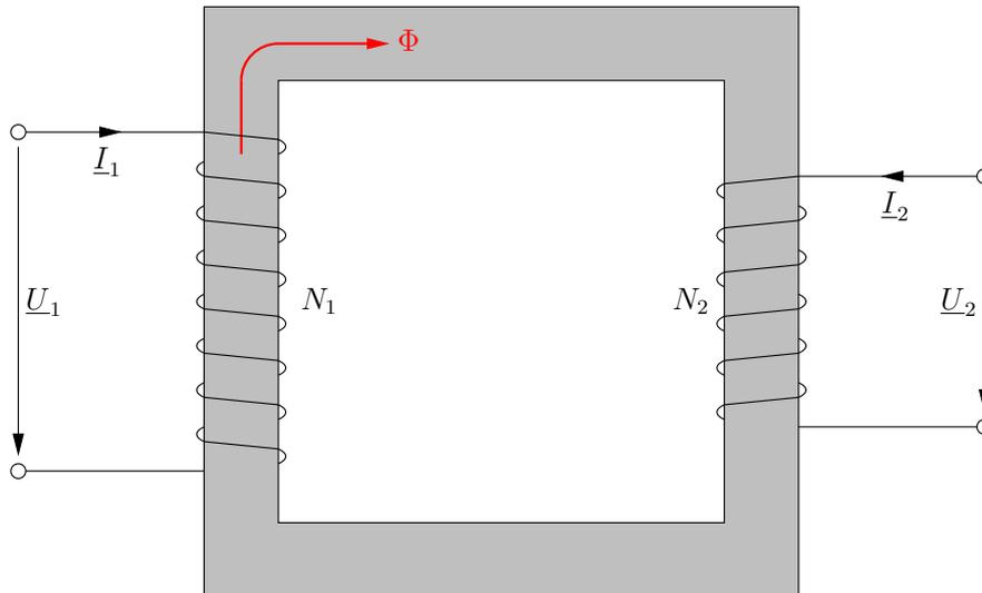
Der Zusammenhang zwischen den Spannungen und Strömen auf der Primär- und Sekundärseite lässt sich über die Betrachtung des magnetischen Kreises berechnen. Da uns an dieser Stelle noch das notwendige Fachwissen fehlt, verzichten wir auf die Herleitung der einzelnen Formeln. Der T-Ersatzschaltbild des Transformators ist auch ohne ein tiefes Verständnis für die inneren Vorgänge recht anschaulich nachzuvollziehen.
