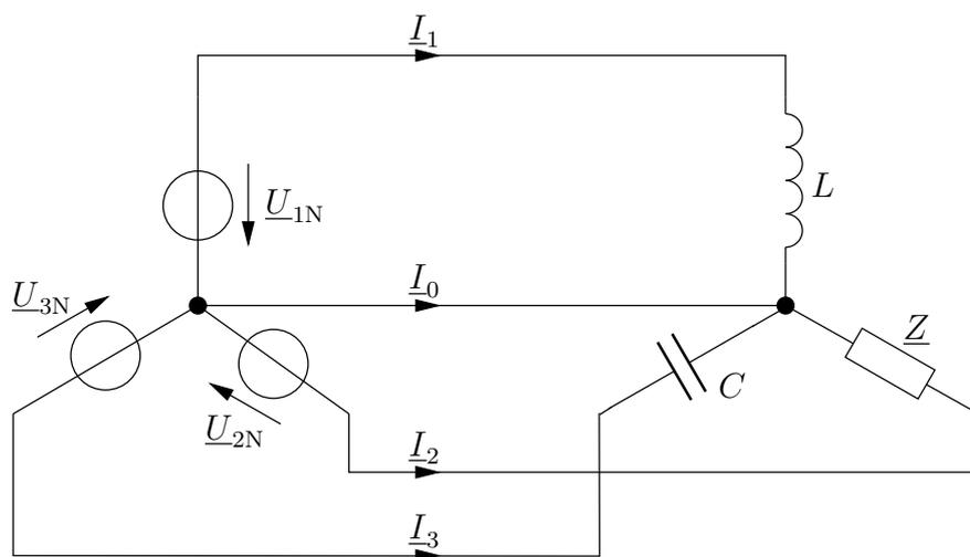
Die Wechselspannungsquellen bilden ein Drehstrom-Erzeugersystem:
