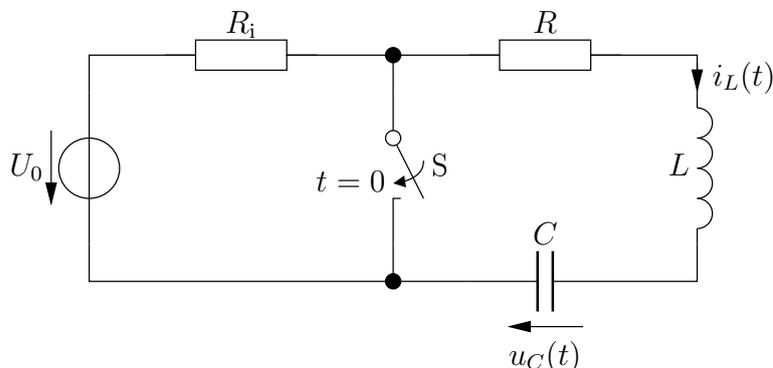
Abbildung 8.3.: Beispielschaltung. Gesucht ist der zeitliche Verlauf von  $i_L(t)$ .
