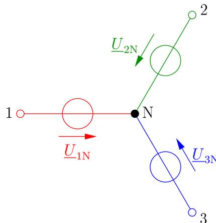
Die drei Spannungen  $\underline{U}_{1N}$ ,  $\underline{U}_{2N}$  und  $\underline{U}_{3N}$  werden auch **Strangspannungen** genannt. Definiert man die Phase von  $\underline{U}_{1N}$  als Nullphasenwinkel, so ergibt sich
