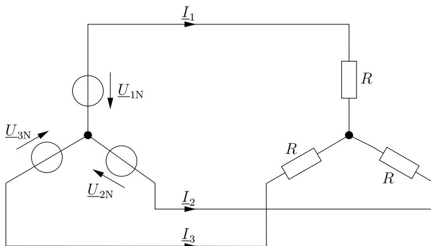
Die Wechselspannungsquellen bilden ein Drehstrom-Erzeugersystem:
