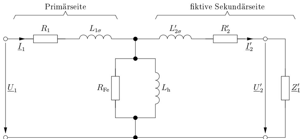
Bei den Größen auf der fiktiven Sekundärseite ( $L'_{2\sigma}$ ,  $R'_2$ ,  $\underline{U}'_2$  und  $\underline{I}'_2$ ) handelt es sich um Ersatzgrößen, die es ermöglichen die unterschiedlichen Strom- und Spannungslevel der beiden Transformatorseiten in einem Schaltbild zu betrachten. Zwischen den realen und fiktiven Größen der Sekundärseite bestehen folgenden Zusammenhänge:
